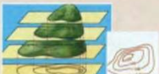
Изображение рельефа с помощью линий равной высоты — горизонталей
